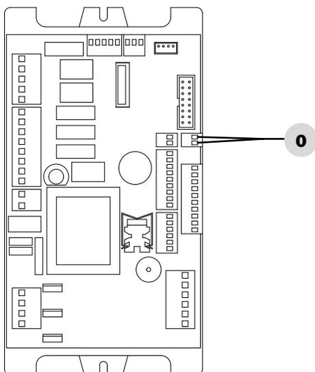
POSITION RACCORDEMENT ÉLECTRIQUE TABLEAU DE COMMANDE
