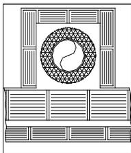
Cheminée en acier AISI 316 à double chambre isolée avec de la fibre céramique ou produit équivalent résistant à 400°C.
