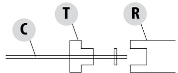
RACCORDEMENT MANOMÈTRE AU KIT HYDRAULIQUE (réservoir Refill)
