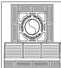
Cheminée en matériau réfractaire à double chambre isolée et gaine extérieure en béton allégé avec matériau alvéolaire type argile.
