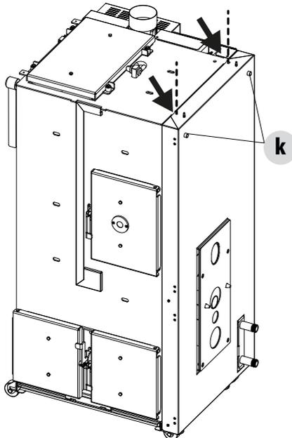
Monter les deux protections en caoutchouc "k" présentes dans la boîte des vis placée dans le réservoir (manuel/Refill).
