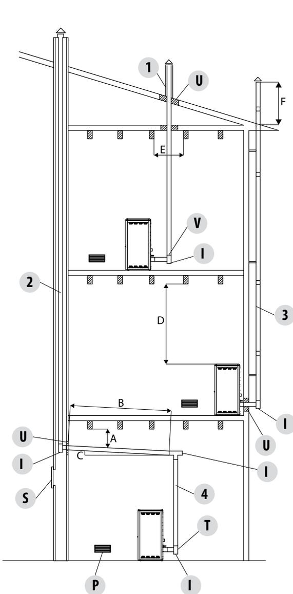
**1.** Installation du conduit de fumée Ø150 mm avec un trou pour le passage du tube de plus de :
