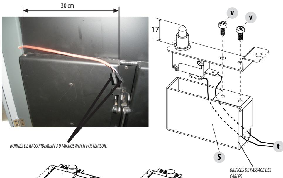
BORNES DE RACCORDEMENT AU MICROSWITCH POSTÉRIEUR.
