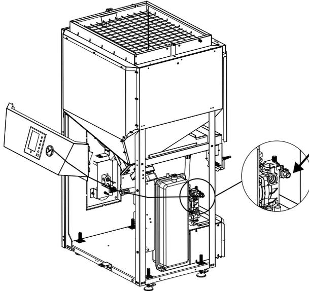
RACCORDEMENT MANOMÈTRE AU KIT HYDRAULIQUE (réservoir manuel)
