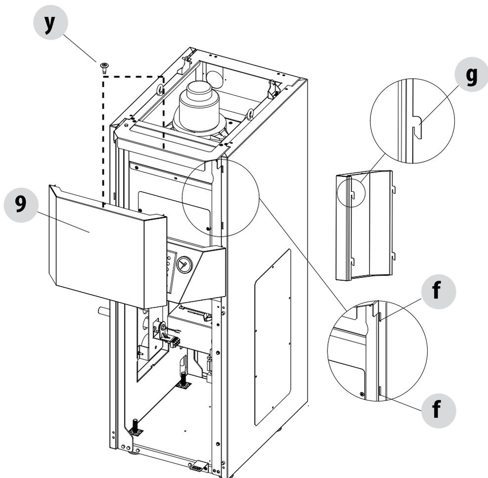
ASSEMBLAGE PANNEAU SUPÉRIEUR (RÉSERVOIR REFILL)
