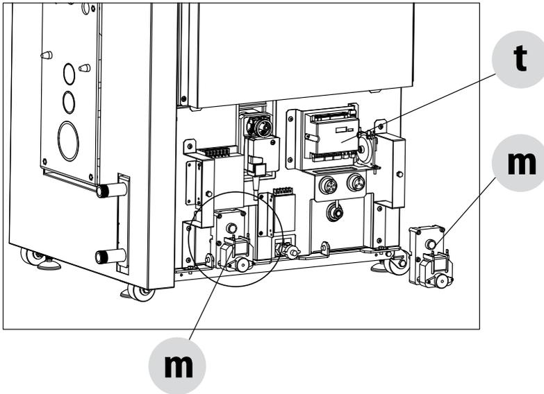
Raccorder un câble électrique avec des bornes à faston femelle 6,3x0,8 et un couvre-faston au moto-réducteur. Brancher l'autre extrémité du câble dotée d'une fiche Schuko au réseau électrique jusqu'à ce que la face plate de l'arbre du moto-réducteur sera perpendiculaire à la vis "h" (pos.2) de l'entraîneur. Après avoir débranché le câble du motoréducteur, insérer maintenant l'arbre du motoréducteur dans la portion de vis sans fin qui dépasse. Serrer la vis "h" (clé 10).
